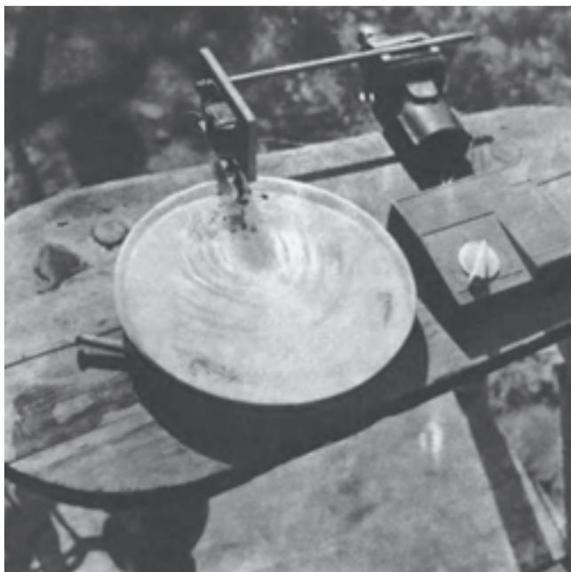
Рис. 1. Установка для наблюдения волн от одиночного источника
